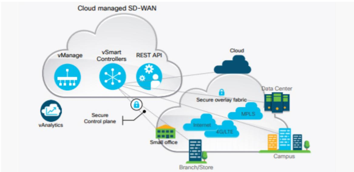
Tehničko rješenje zasniva se na Cisco SD-WAN rješenju koje se sastoji od centralnih upravljačkih komponenti koje čine SDN kontroler (vManage, vBond i vSmart).
